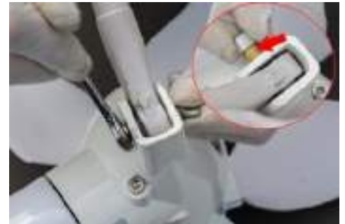
3. Recuerda insertar el tubo de cobre antes de montar la cola.
