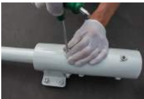
7. Apriete los tres tornillos más largos en el Zócalo de conexión
