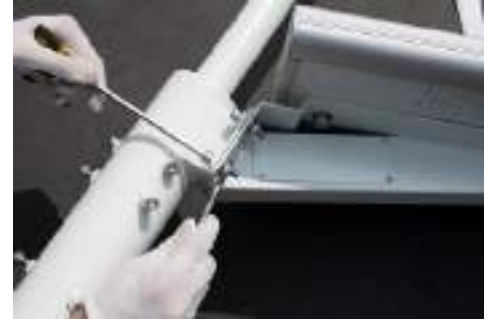
9. Fije la luz en el Zócalo con tornillos e inserte los cables de la turbina eólica en el soporte
