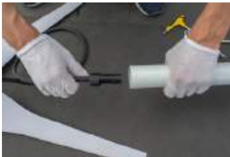
4. Inserte los cables de la Turbina Eólica en la toma de corriente
